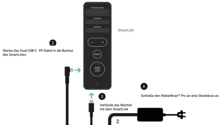
Grafik 6: Verbindung zwischen SmartLink und Stromversorgung
